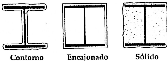
Figura 2: Técnica de ignifugación en cuatro lados
